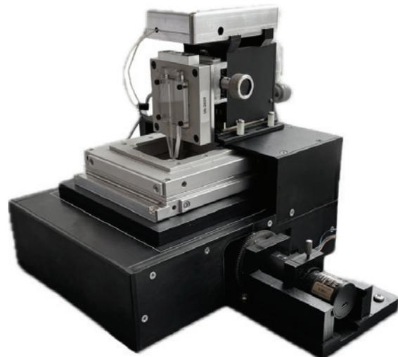
**Рис. 1.** Механическая система сканирующего капиллярного микроскопа FemtoScan Xi. Диапазон прецизионных перемещений по осям X, Y, Z – 50 мкм, 50 мкм, 30 мкм; точность перемещения – 0,05 нм. Диапазон плавного автоматического перемещения по осям X и Y составляет 12 мм. Встроенная инвертированная оптическая система обеспечивает наблюдение за образцом и положением капилляра.
